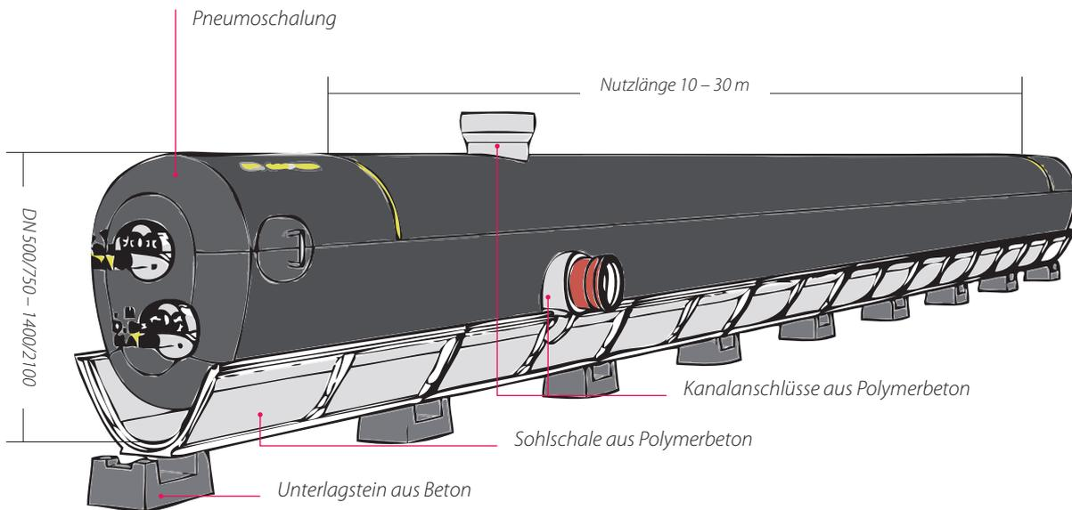
Pneumoschalung, die Sohlschale aus Polymerbeton und Unterlagstein sind **perfekt** aufeinander abgestimmte **Systemkomponenten**.
